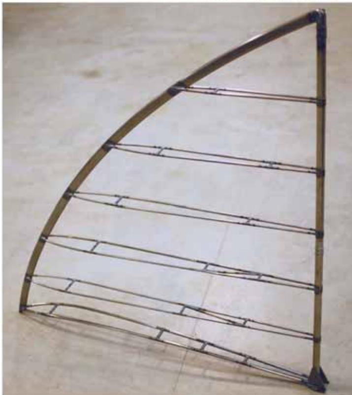
Per cortesia della Aerosviluppi di Lonate Pozzolo (VA) in questa foto vediamo la deriva realizzata dalla ditta per l'S55 da esporre a Volandia: è il primo pezzo della replica dell'aereo per il Museo,
